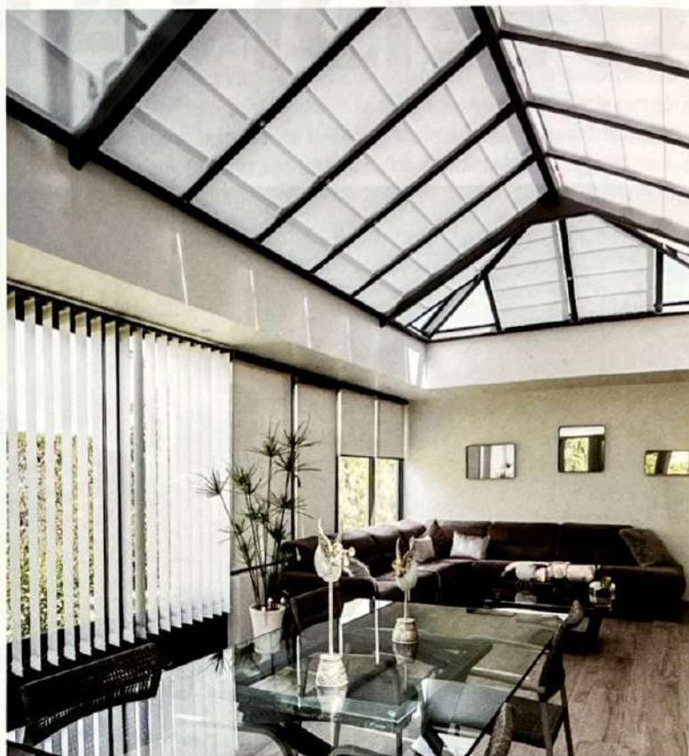
*Store vélum coulissant sur des rails en aluminium thermolaqués à la couleur de la véranda, il met en avant le raffinement du textile, assure la protection solaire et l'isolation thermique des toitures vitrées, inclinées ou horizontales. REFLEX'SOL*
