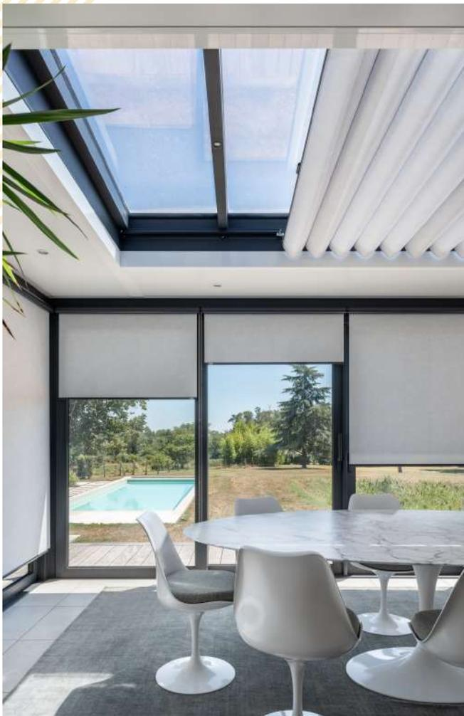
Issues de la recherche spatiale, les toiles REFLEX'SOL sont composées d'une face réfléchissante métallisée qui renvoie le rayonnement solaire à l'extérieur et empêche le réchauffement des pièces vitrées. C'est la solution de protection solaire idéale pour les puits de lumière. Non seulement elles vous protègent mieux de la chaleur que toutes les protections solaires extérieures, et en plus elles ne sont pas soumises aux intempéries et à leurs aléas.
